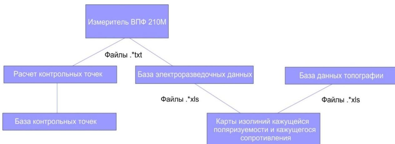
Рисунок 4.7 – Этапы обработки электроразведочных данных ВП-СГ
